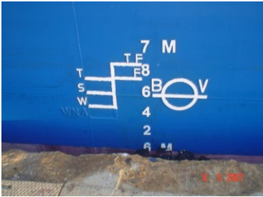
Die Lademarken und die Tiefgangmarken eines Frachters. BV bezeichnet die Klassifikationsgesellschaft, in unserem Fall für
