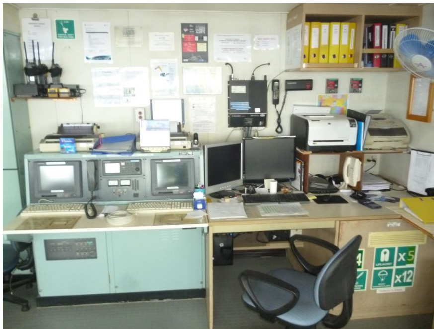
Die Kommunikationskonsole (links) für den kommerziellen Verkehr und für GMDSS für das Fahrtgebiet A3 auf der SCL BERN (Bild: Stefan Sip)
